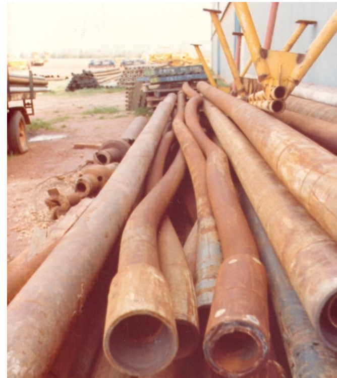
Aste di perforazione di un impianto con martello fondo foro, dopo una caduta di 18 m per mancata tenuta del martinetto in superficie (Cirenaica, Libia)
